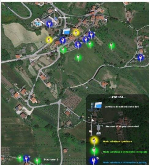
Disposizione degli apparati del sistema di monitoraggio della frana di Ponzano
