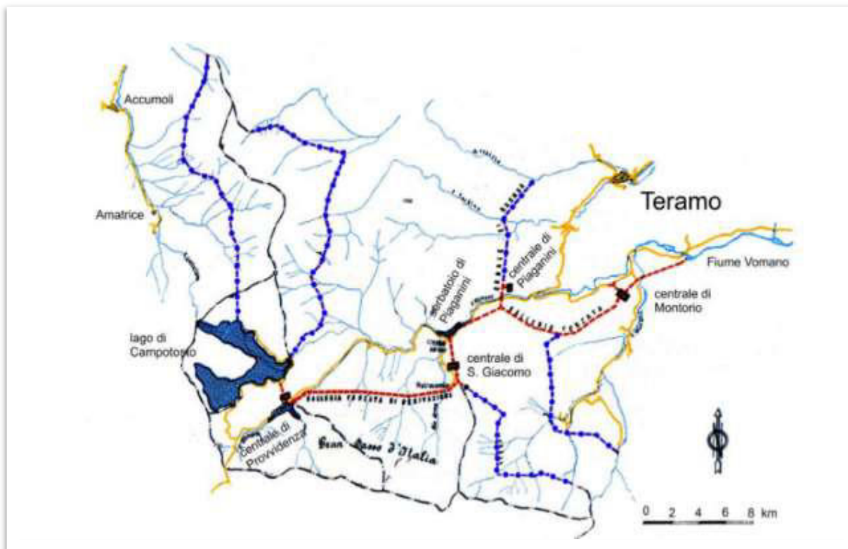
Fig. 9: Partendo dal lago di Campotosto, si incontrano in successione tre centrali elettriche, ognuna delle quali è alimentata dalle acque di scarico della precedente attraverso un articolato sistema di gallerie di derivazione e pozzi
