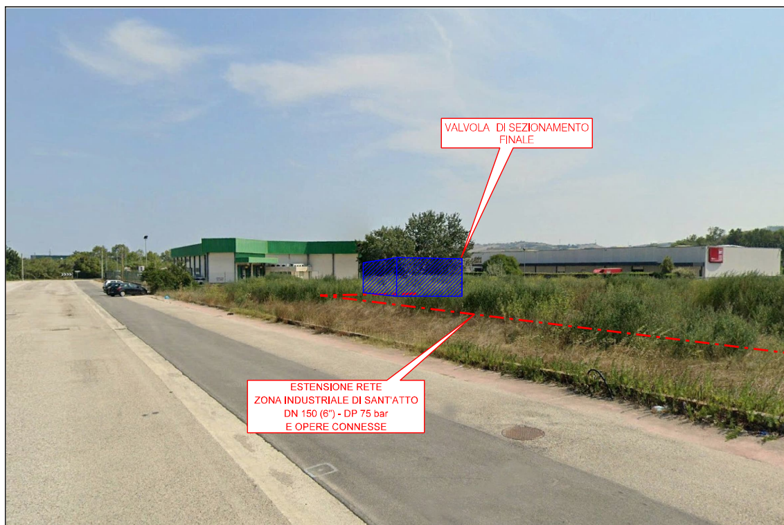
FOTO 33: Area ubicazione punto finale gasdotto in progetto
