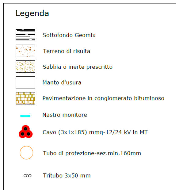
Figura 4 – Sezioni di scavo previste nel progetto e legenda
