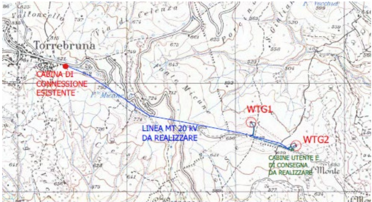
Linea elettrica di collegamento alla rete di E-Distribuzione
