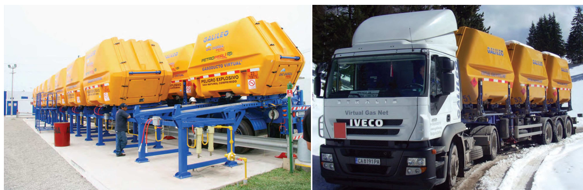
Figura 7: Sistemi di trasporto pressurizzati – il sistema Galileo “virtual pipeline”; Fonte: Galileo SA
