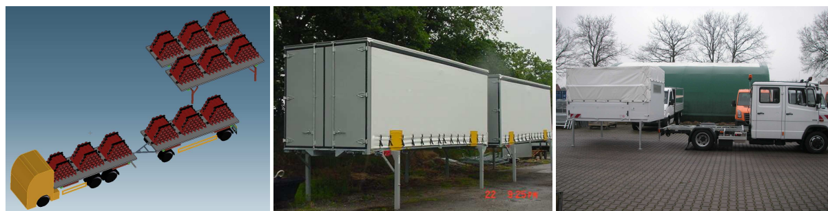
Figura 6: Sistemi di trasporto pressurizzati con sistema WAB: Fonte: Güssing Energy Technologies GmbH, Schoon Fahrzeugsysteme
