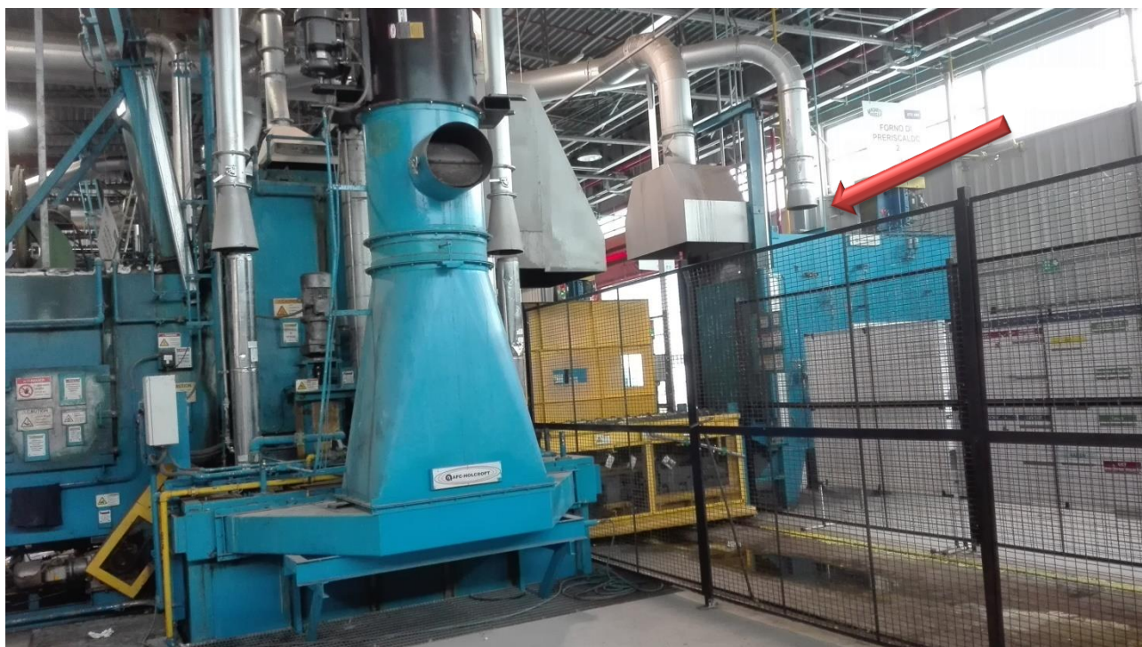
foto 1: si evidenzia il punto di emissione del forno di preriscaldamento, privo di camino proprio. Nel testo se ne suggerisce la modifica con innalzamento della cappa ed interposizione di un camino dedicato e campionabile.
