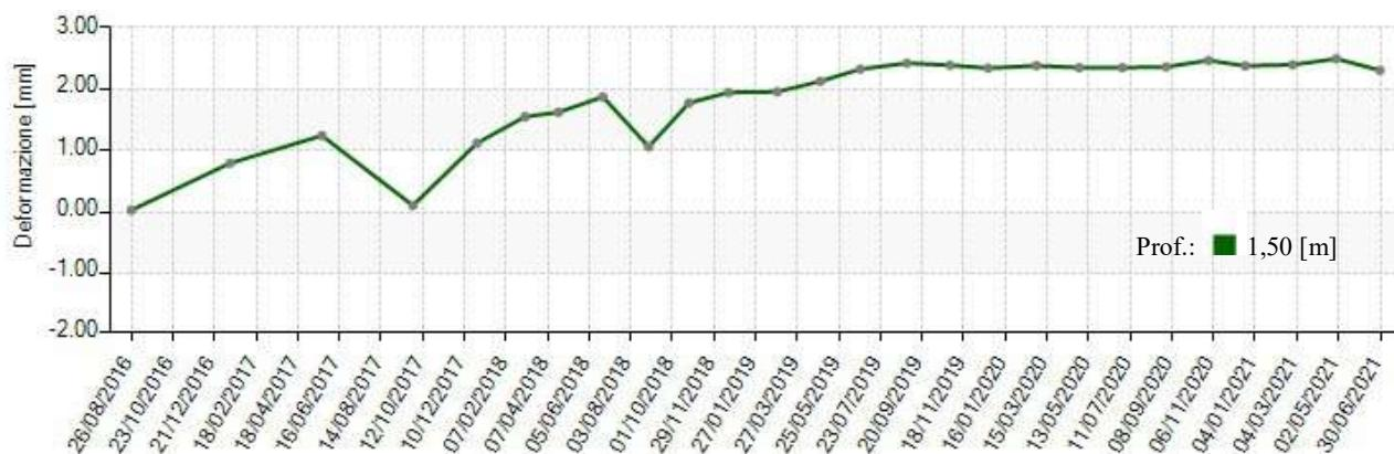
Durante il corso del monitoraggio è andato gradualmente mutando lo stato dei luoghi nell'immediato intorno del tubo inclinometrico per la realizzazione di alcuni lavori, tra i quali la riprofilatura della scarpata con sistemazione di una gabbionata a valle del tubo, l'installazione di pozzetti esterni di protezione in cls, la posa di canaline di scolo, ecc.
