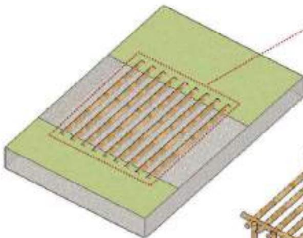
struttura in legno per il mantenimento di tratti erosi acclivi ottenuta mediante scavo del pacchetto interessato, orditura di pali a sezione circolare infissi con piantoni come disegno sottostante, riempitura a colmare di misto di cava o ghiaino opportunamente compattato
