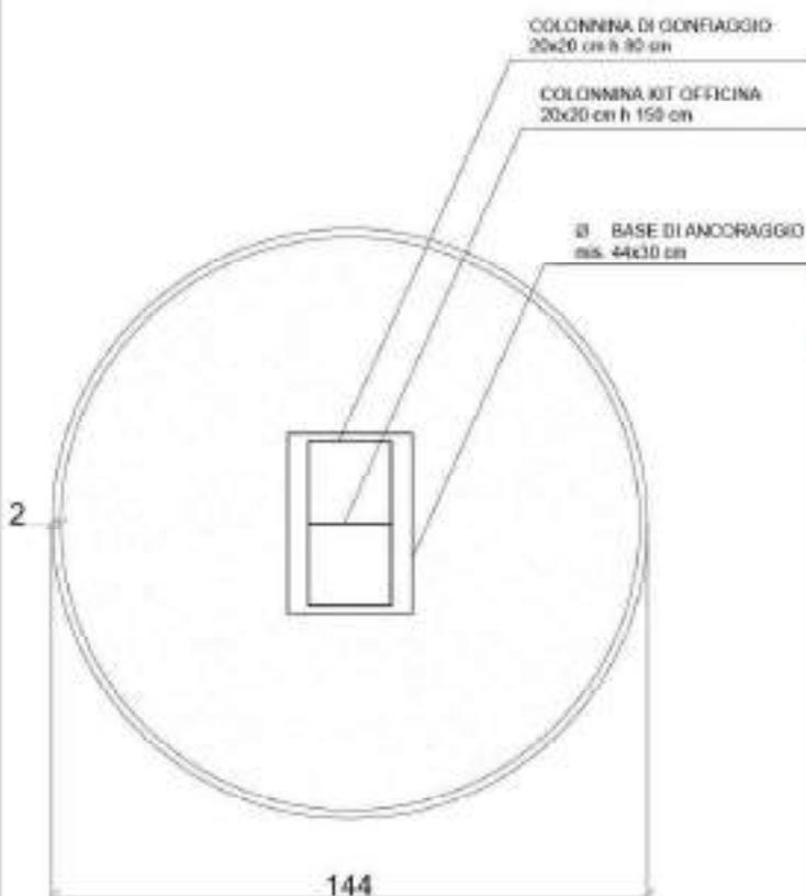
La stazione di riparazione bici è adatta per ogni tipo, modello e misura di bicicletta. La colonnina è dotata di attrezzi per la manutenzione e di pompa di gonfiaggio pneumatici, con attacco universale. La struttura è realizzata in alluminio anticorrosione. E' installata su un basamento in cls, realizzato in opera.
