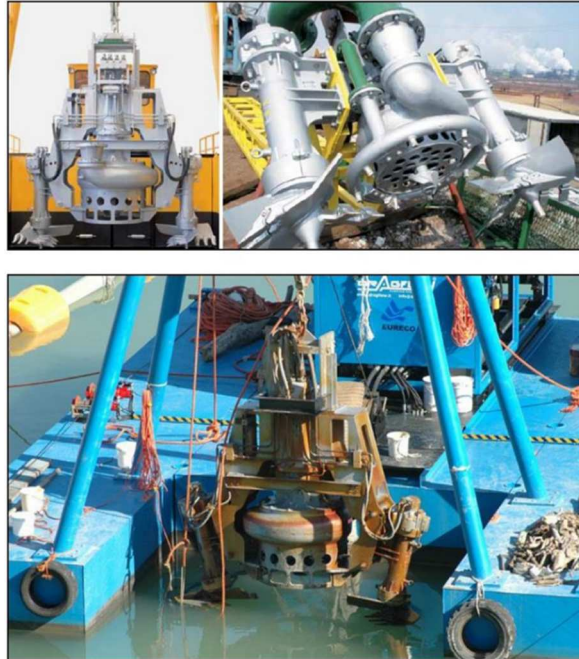
Esempio di pompa dragante con disgregatori, manovrata tramite pontone galleggiante di appoggio
