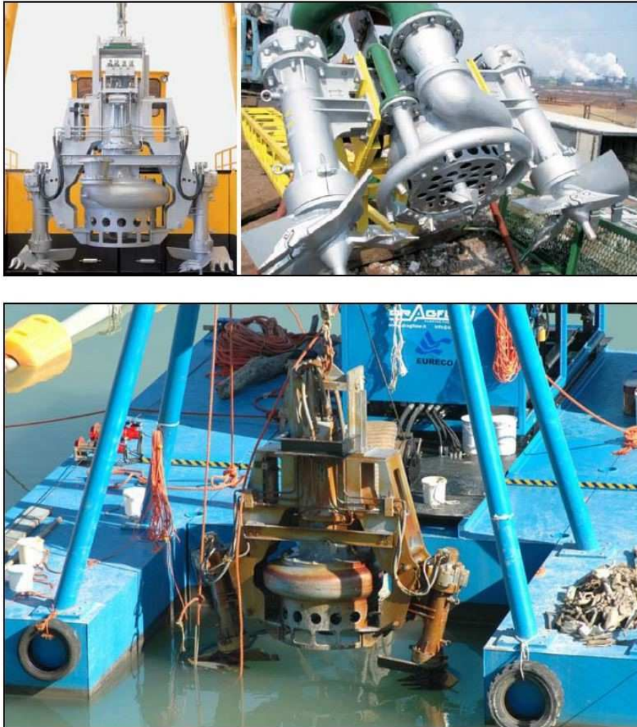
Figura 4-3: esempio di pompa dragante con disagregatori, manovrata tramite pontone galleggiante di appoggio
