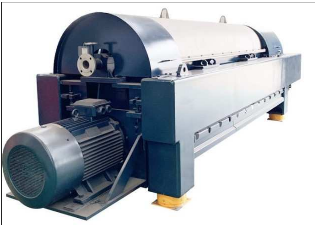
Figura 4-12: esempio di impianto a centrifuga
