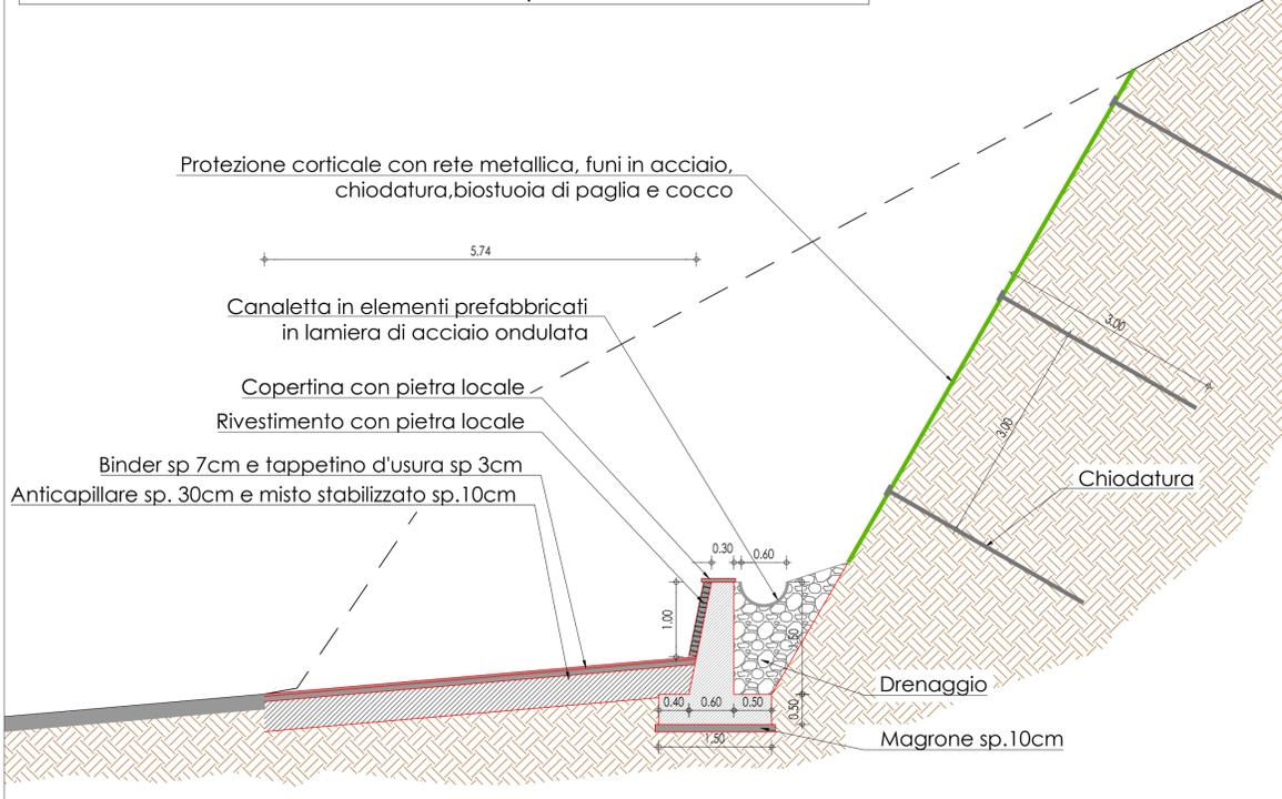
Particolare costruttivo terramesh system\_scala 1:50
