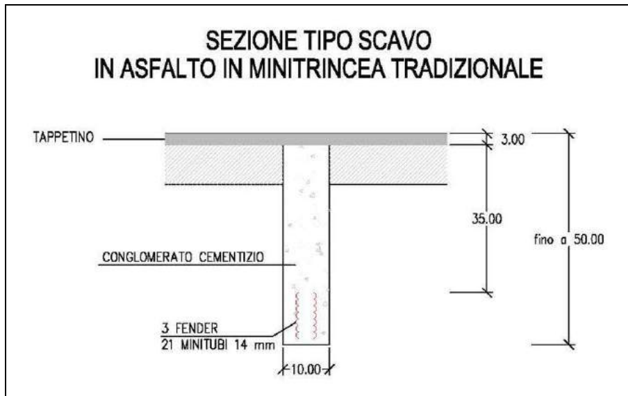
Figura 43: Particolare tipo di scavo in minitrincea (fuori scala)
