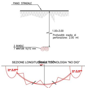
SEZIONE TIPO SCAVO IN ASFALTO IN MINITRINCEA TRADIZIONALE
