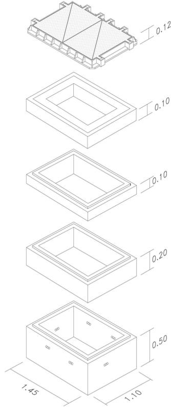
POZZETTO MODULARE IN CALCESTRUZZO FIBRORINFORZATO TIPO 76X40 disegno non in scala
