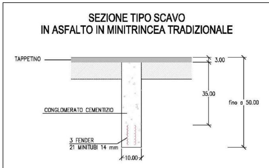
Figura 15: Particolare tipo di scavo in minitrincea (fuori scala)
