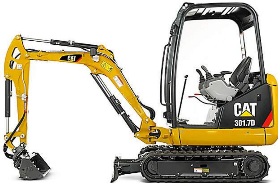
Figura 16: Vista di un miniescavatore tipo per la realizzazione degli scavi tradizionali
