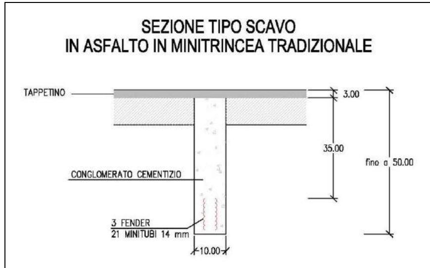
Figura 12: Particolare tipo di scavo in minitrincea (fuori scala)
