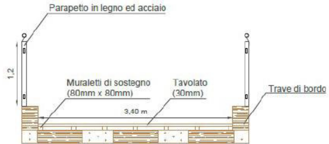
SEZIONE A-A scala 1:50
