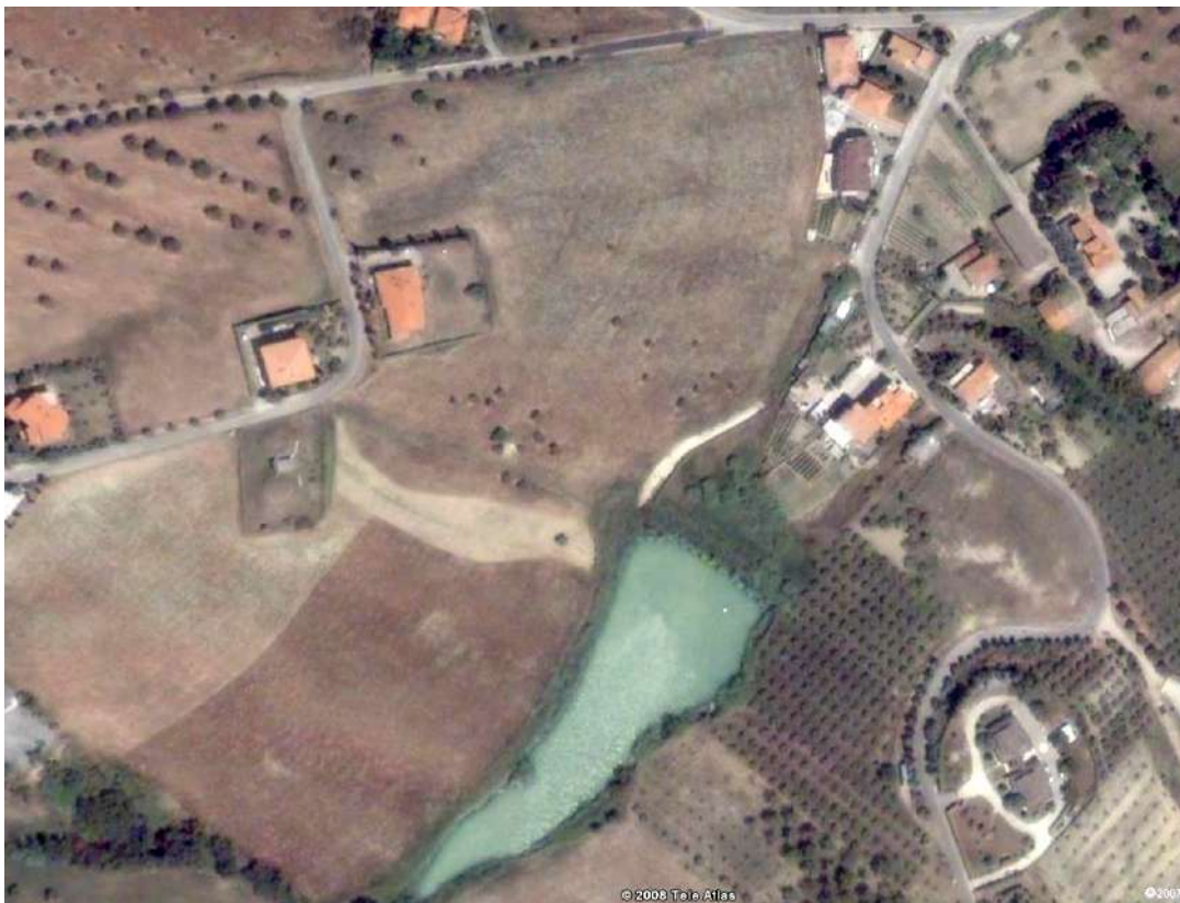
Fig. 8 – Invaso collinare n. 1, il più vicino alla fascia costiera, con altezza dello sbarramento pari a 10 m e volume d'acqua di circa 40.000 m 3 .
