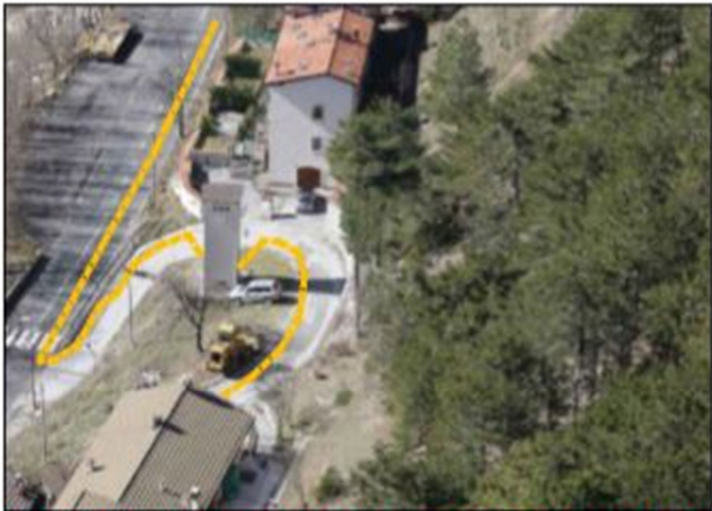
FOTO N. 3/BIS CAB. REGINA ARRIVO IN CAVO INTERRATO C.P. USCITA DIREZ. NODO 170088, TRANSITO SU S.S. 83
