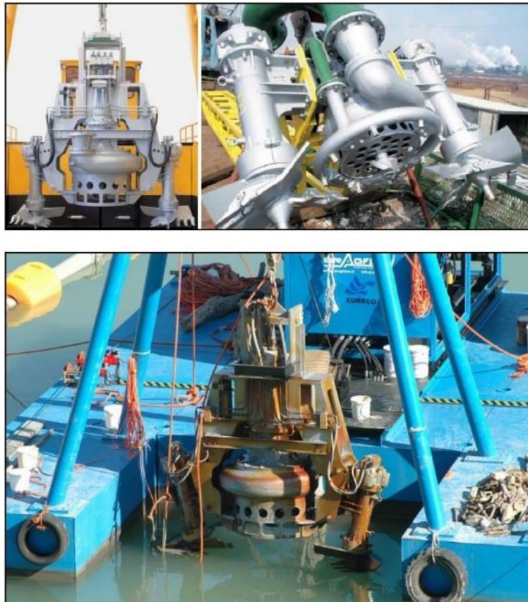
Figura 6.2.2: Esempio di pompa dragante con disgregatori, manovrata tramite pontone galleggiante di appoggio
