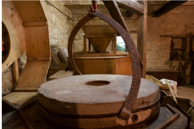
Fig. 16 Ruota di pietra dura del mulino ad acqua di Arsita
