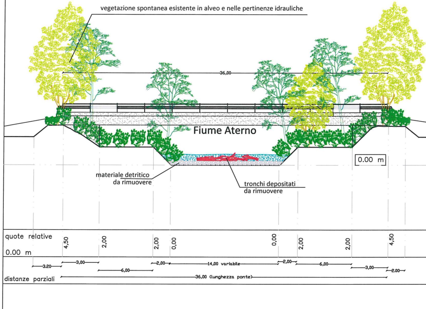
N.B. Le misure riportate sono state dedotte dal rilievo celerimetrico svolto con rotella metrica, triplometro ed asta graduata.
