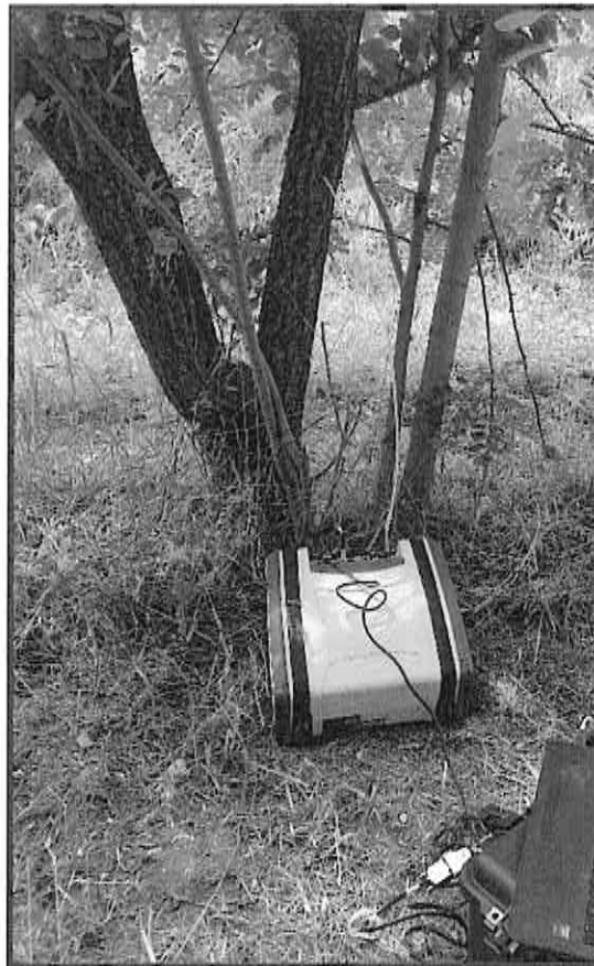
Figura 11 Campionamento in vivo tramite FT-IR
