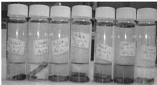
Figura 7 Vial con tappo in teflon utilizzato per la conservazione del campione.
