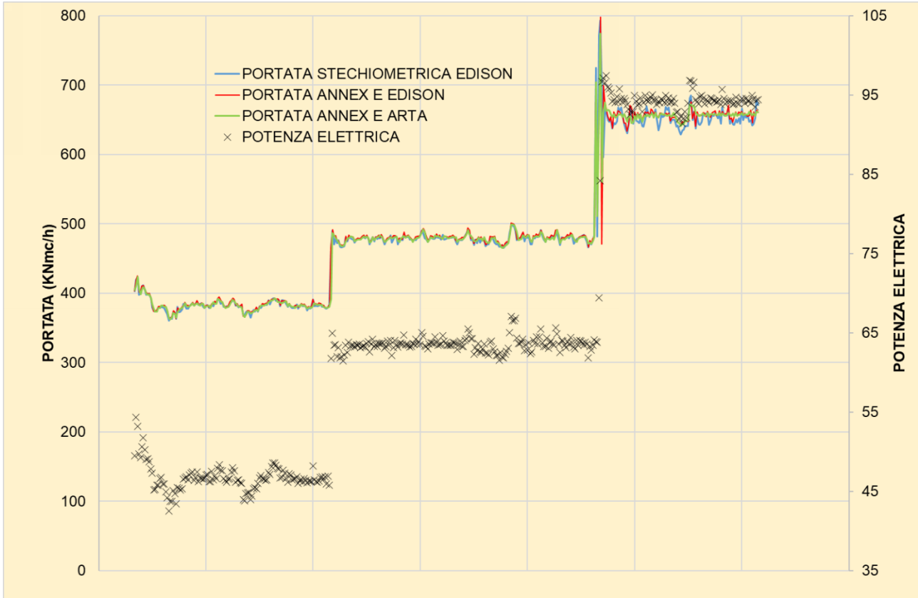
FIGURA 2: ANDAMENTO DELLE PORTATE CALCOLATE (CAMINO E1) CON I DIVERSI ALGORITMI E CONFRONTO CON LE VARIAZIONI DI CARICO
