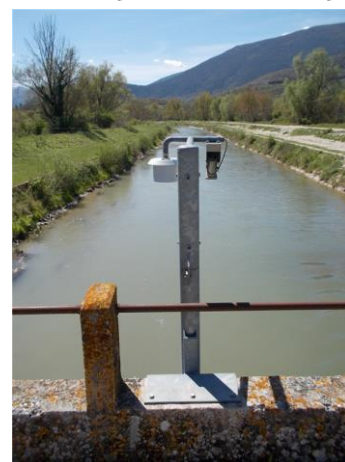
Figura 19 Sensore idrometrico e sensore di velocità superficiale
