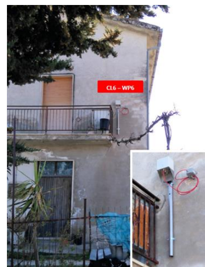
Figura 21: Sistema di monitoraggio frane: clinometri da parete
