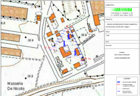
Foto 4. Stralcio relazione aziendale del 24/01/2018. Direzione di flusso della falda profonda: NNO
