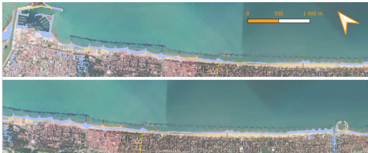
Figura 5-1: Mappe di allagamento statico per il tempo di ritorno pari a 2 anni e l'orizzonte temporale del 2040.
