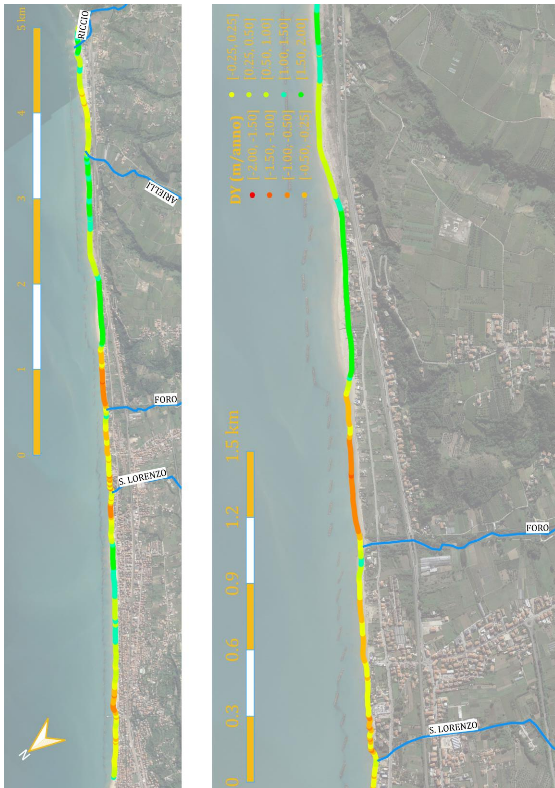
Figura 6-2: Analisi della tendenza evolutiva recente del litorale. Evoluzione della linea di riva nel periodo 1997-2018. Dettaglio tra la Foce del San Lorenzo e la frazione Foro del Comune di Ortona.
