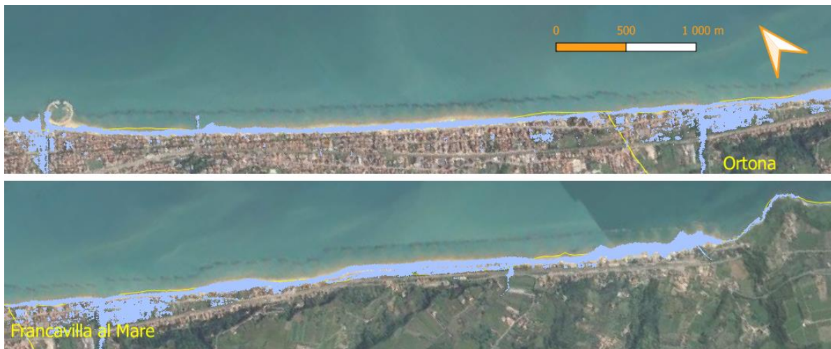
Figura 5-2: Mappe di allagamento statico per il tempo di ritorno pari a 50 anni e l'orizzonte temporale del 2040.
