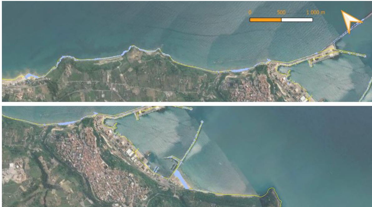
Figura 5-1: Mappe di allagamento statico per il tempo di ritorno pari a 2 anni e l'orizzonte temporale del 2040.
