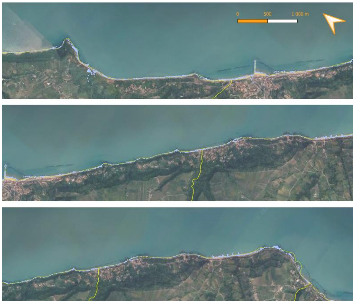
Figura 5-1: Mappe di allagamento statico per il tempo di ritorno pari a 2 anni e l'orizzonte temporale del 2040.
