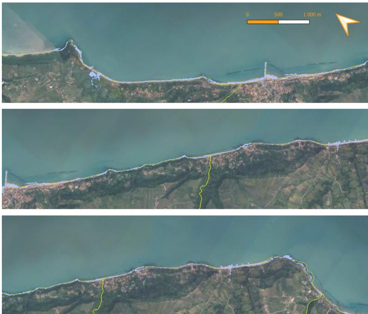
Figura 5-2: Mappe di allagamento statico per il tempo di ritorno pari a 50 anni e l'orizzonte temporale del 2040.
