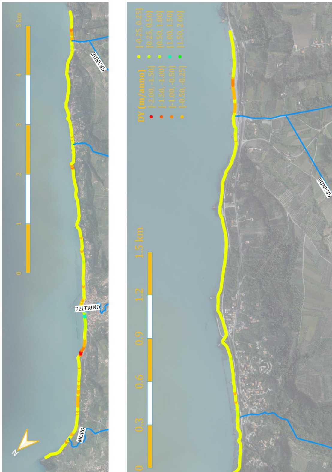
Figura 6-3: Analisi della tendenza evolutiva recente del litorale. Evoluzione della linea di riva nel periodo 1997-2018. Dettaglio tra la località San Fino (San Vito Chietino) e Punta Cavalluccio.
