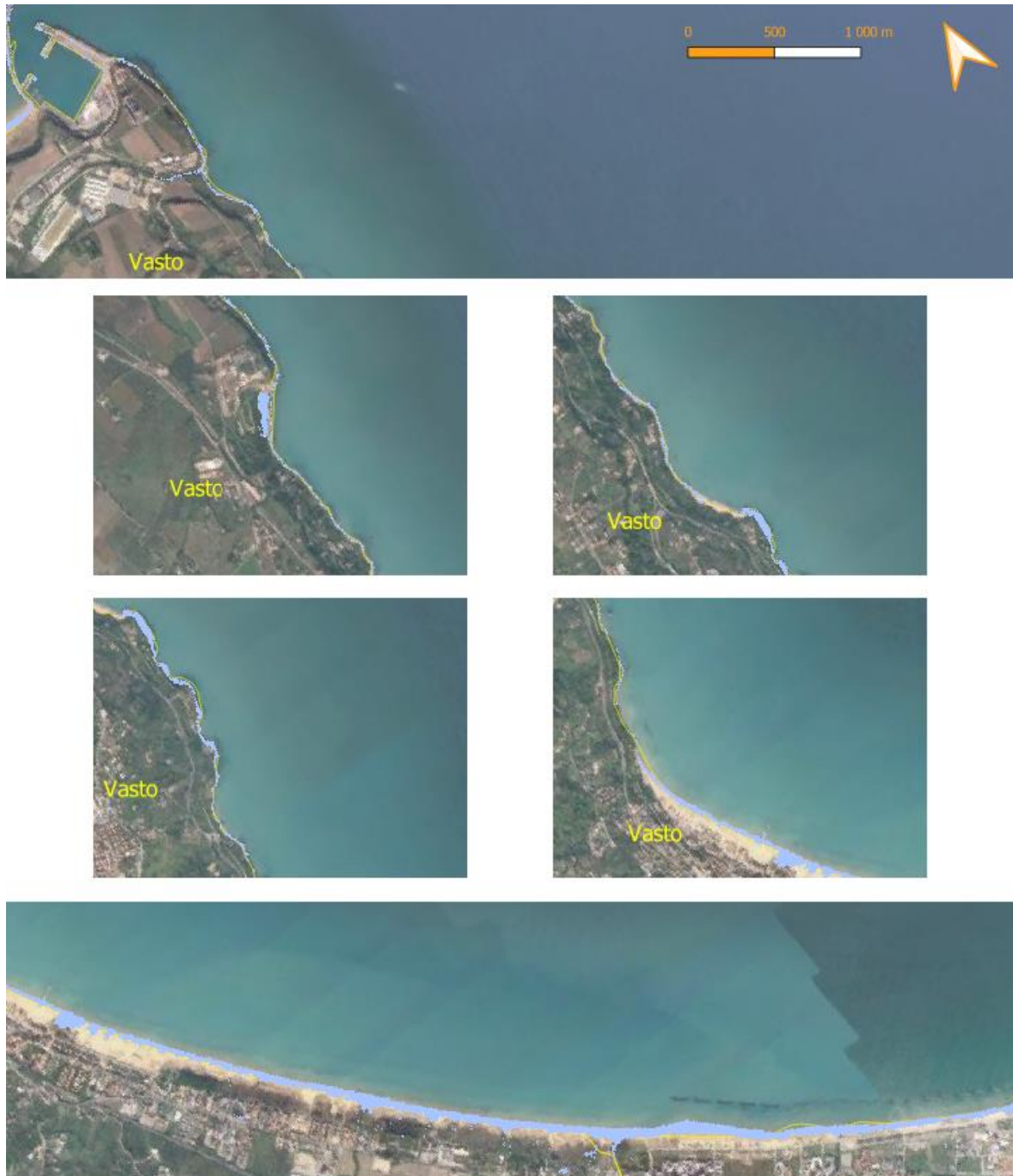
Figura 5-1: Mappe di allagamento statico per il tempo di ritorno pari a 2 anni e l'orizzonte temporale del 2040.
