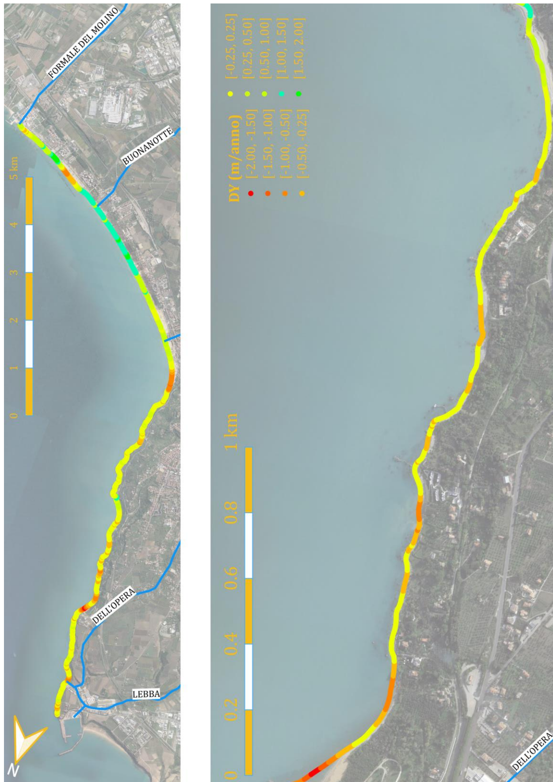
Figura 6-2: Analisi della tendenza evolutiva recente del litorale. Evoluzione della linea di riva nel periodo 1997-2018. Dettaglio tra la località Vignola e la spiaggia di San Nicola.
