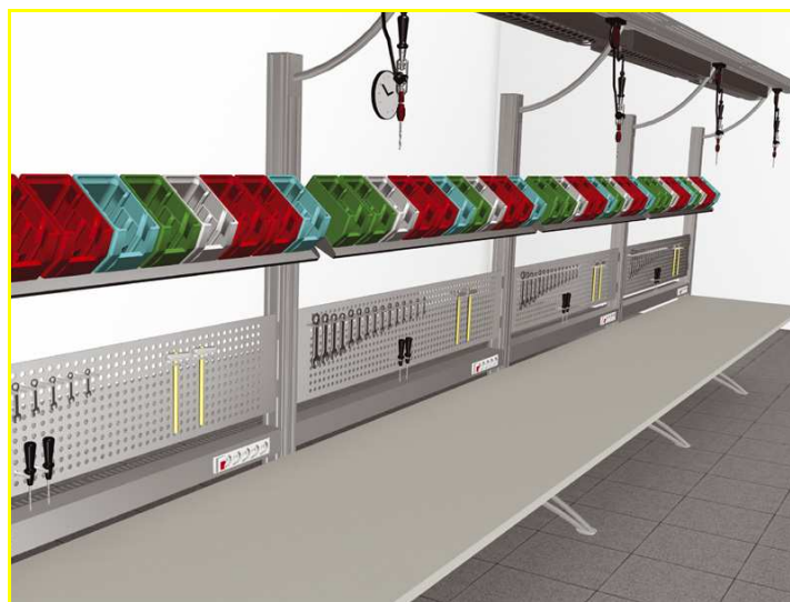
Fig. 3 – Banco tipo per il disassemblaggio dei RAEE
